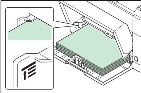
Falls Sie einen größeren Stapel dickes Papier in die Kassette einlegen, wird es möglicherweise nicht eingezogen. In diesem Fall verringern Sie die Menge des eingelegten Papiers.
