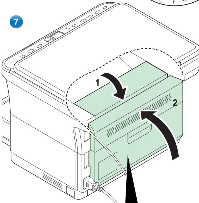
Schließen Sie die hintere Abdeckung, um den Fehler zu beheben. Das Gerät heizt auf und setzt den Druckvorgang fort.
