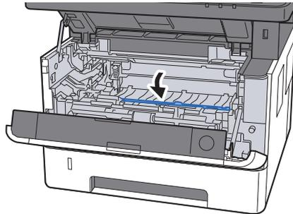
12 Trommeleinheit in die ursprüngliche Position einsetzen.
