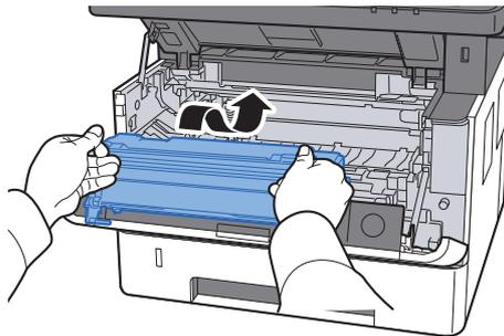
13 Entwicklereinheit mit den Tonerbehälter wieder einsetzen, indem Sie diese wieder mit beiden Händen entlang der Führungen in das Gerät einsetzen.
